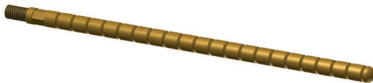
Abb. 4.4: CAD-Modell einer Arretierstange
